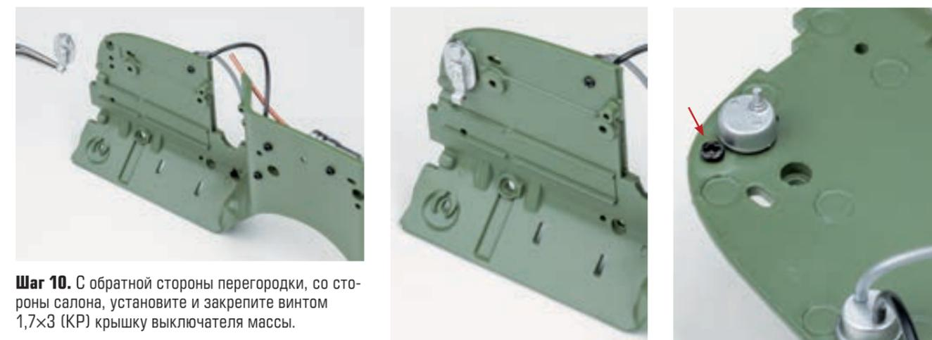
**Шаг 10.** С обратной стороны перегородки, со стороны салона, установите и закрепите винтом 1,7×3 (KP) крышку выключателя массы.
