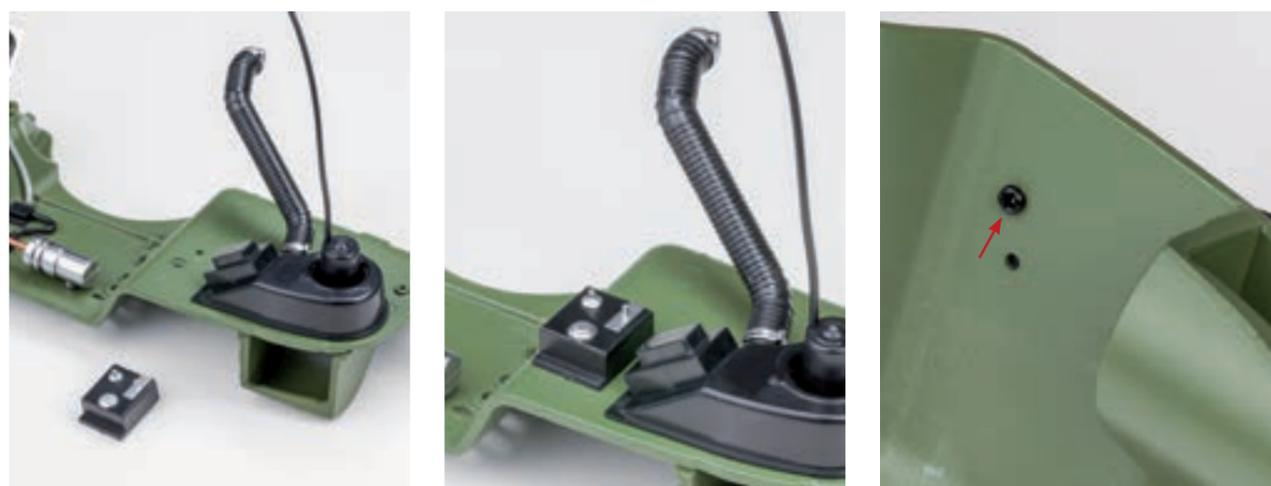
**Шаг 7.** На перегородку моторного отсека, рядом с установленным ранее кожухом вентилятора отопителя, поместите щиток управления предпускового подогревателя. Для фиксации детали используйте винт 1,7×4 (AP).
