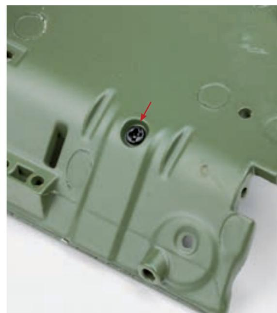
**Шаг 13.** Проденьте трубку бачка стеклоомывателя в отверстие перегородки моторного отсека, расположенное в верхней части рядом с выключателем массы.
