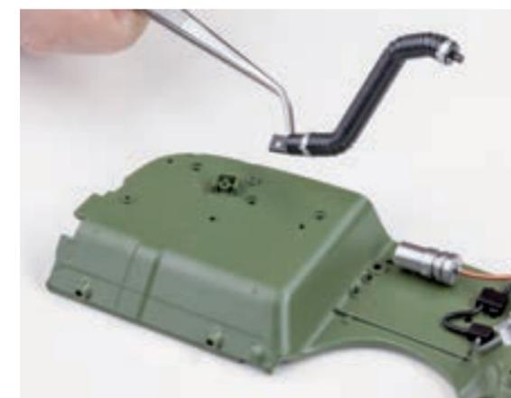
**Шаг 4.** Установите шланг предпускового подогревателя в правой половине перегородки моторного отсека. Закрепите шланг винтом 1,7×4 (СМ).
