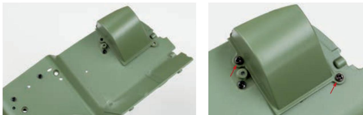
**Шаг 6.** На внутренней стороне перегородки моторного отсека, в ее правой половине, установите и закрепите двумя винтами 1,7×4 (CM) приемный кожух.
