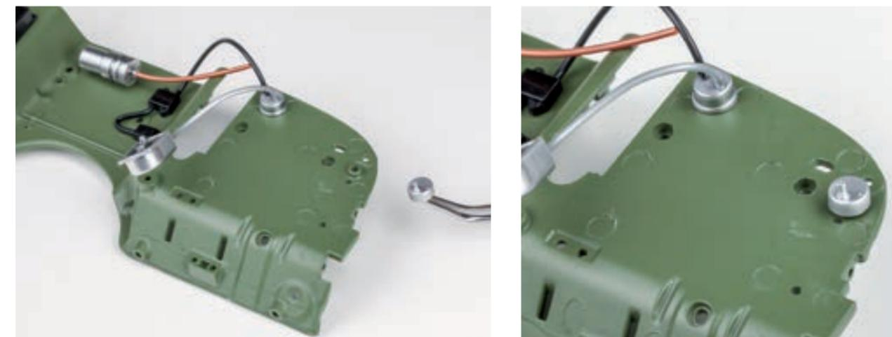
**Шаг 9.** В левой половине перегородки моторного отсека, со стороны двигателя, установите корпус выключателя массы. Плотнo прижмите деталь к перегородке.
