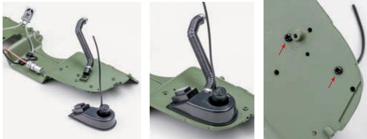
**Шаг 5.** Накройте установленный ранее шланг кожухом вентилятора отопителя. Совместите крепежные отверстия кожуха и перегородки и закрепите детали двумя винтами 1,7×4 (AP) с обратной стороны перегородки.
