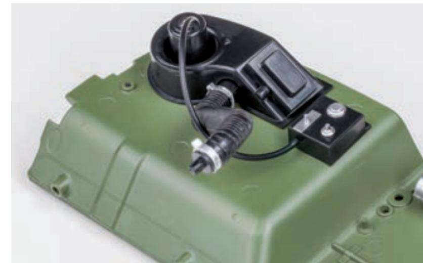
**Шаг 8.** Закрепите свободный конец провода мотора вентилятора на нижнем крепежном штыре корпуса щитка управления предпускового подогревателя.
