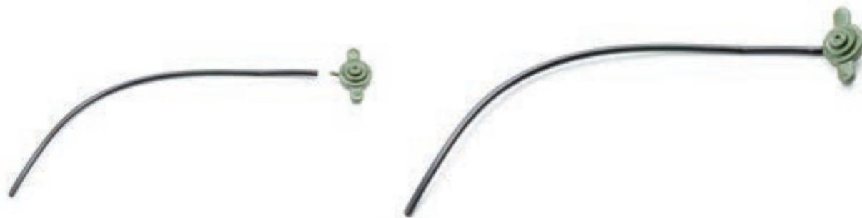
**Шаг 11.** На корпусе ножного насоса стеклоомывателя закрепите трубку бачка стеклоомывателя длиной 90 мм.
