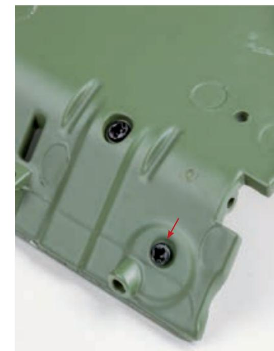
**Шаг 14.** В левом нижнем углу перегородки, со стороны салона, установите и закрепите винтом 1,7×4 (AP) ножной переключатель света.
